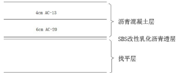
图1 路面结构图
