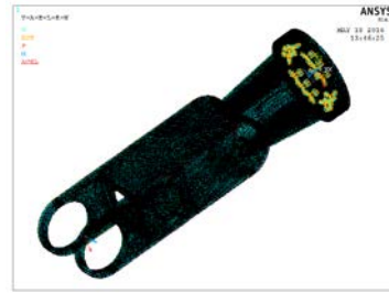
图 2 臂载荷及位移边界条件
