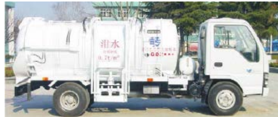
图 1. 一种固液分离的厨余垃圾车
