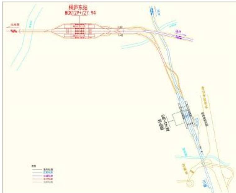
图 1. 新设桐庐东站并设联络线引入桐庐站方案示意图
